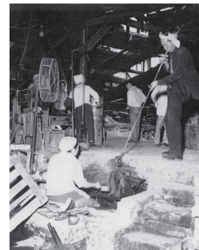
創業当時の中瓶製造風景。優秀な日本のガラス職人たちによる手吹きは難易度が高い作業だったという。
