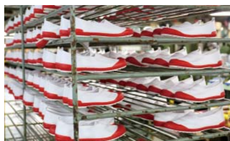
左はオリジナルゴム生地を作るためのゴム練りを行う職人。右は懐かしい学校上履き。インジェクション方式で製造。
