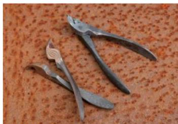
右:職人たちが使う棒やすり。繊細な番手の違いを使い分ける。左:鍛造から上がってきた爪切り。同社工場では同じ仕事の連続で緊張感を無くさないように、定期的に作業現場が入れ替わる。
