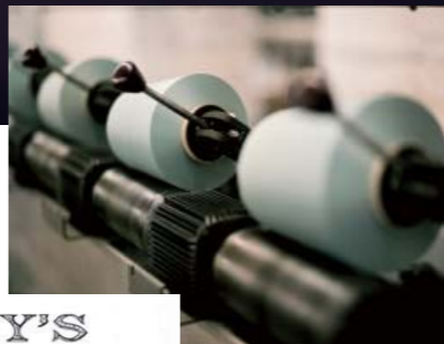
撚糸の工程。糸は品質を安定するためにモイスチャーされる。
