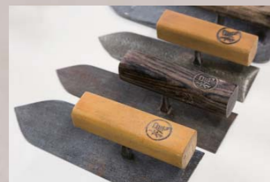
製品のサーフェスを左右する左官職人のコテ。作業の場所によってサイズや形が異なるので何十種類もある。
