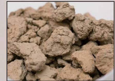
原料となる珪藻土。実際に手に取ってみると判るが、非常に軽い。この原料に水を加えて練ったものを成型していくのだ。
