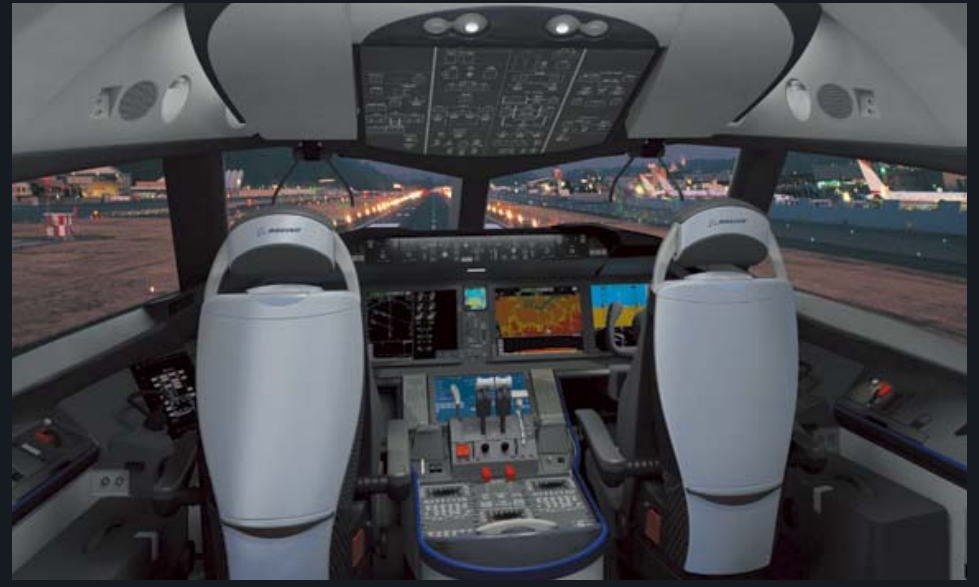
丸型のメーター類はほとんど姿を消した787ドリームライナーのcockpit。大型のLCDのライトが近未来的な光を放つ。
