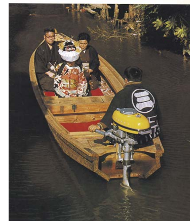
「黄帽子」の船外機を取り付けた和船の録入り船が表紙を飾るヤマハ船外機のカatalog。燃料にガソリンより安いケロシンを使える仕様にするなど、当時の日本がおかれていた経済状況を考えてモノづくりが進められた。
