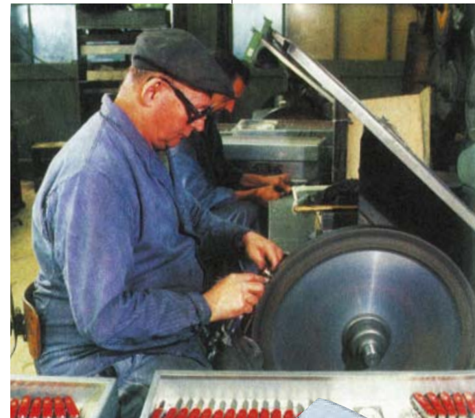
これは1980年代のビクトリノックスの工場のようなものである。ナイフをつくる工程はあらゆる場面で機械化が進んでいるとはいえず、研磨工程には職人が目を注ぐ必要がある。
